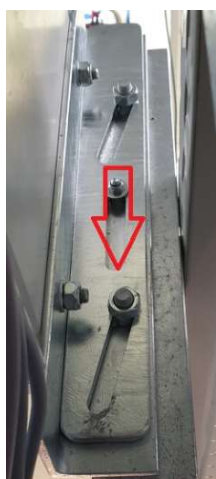
Vyrovnění úhlu na spodní montážní konzole
